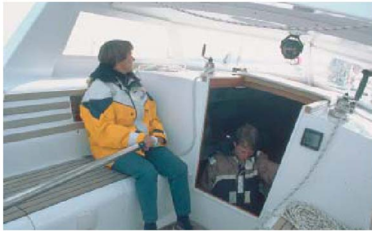
Die Pinne kann dank einer Verlängerung auch vom überdachten Teil des Cockpits aus geführt werden
